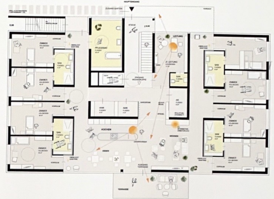
1:100 EINRICHTUNGSVARIANTE - 4 DUBLETTEN ERDGESCHOSS 4 DUBLETTEN - ACHTPERSONENWOHNUNG MIT SANITÄREINHEIT FÜR ZWEI PERSONEN
